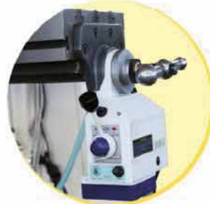
机床可选配电子走刀器 Optional power feed device
